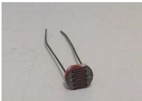
Figura 9 - Sensor de Luminosidade LDR 5mm
