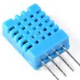
Figura 10 - Sensor de Umidade DHT11
